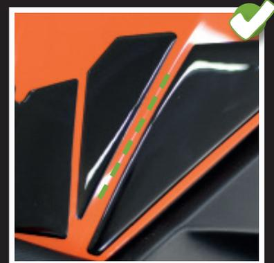
Es empfiehlt sich zwischen dem Pad und stärkeren Sicken / Kanten einen Abstand von ca. 3 mm einzuplanen. Die Klebefläche kann sonst nicht richtig anhaften! Durch die entstehende Spannung im Material, hebt sich das Pad u. U. nach kurzer Zeit wieder ab (s. Bilder Seite 1).
