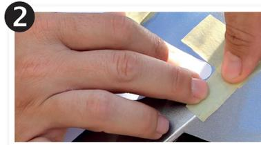
Endposition vor dem Verkleben ausmessen und mit leicht ablösbarem Klebeband (z.B. Malerkrepp) markieren.
