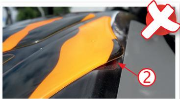
② Ein Klebeversuch über Sicken lässt das Material zu sehr unter Spannung stehen und **löst sich nach kurzer Zeit**.
